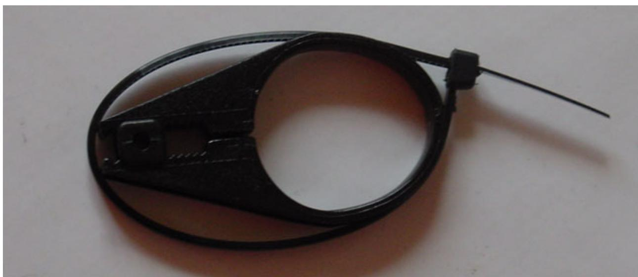
Petite astuce, collez la pièce plastique évitant que la commande sorte du guide. D'une part cela facilite le montage et d'autre part, cela évite de perdre la pièce si le collier venait à casser ou à se détendre.
