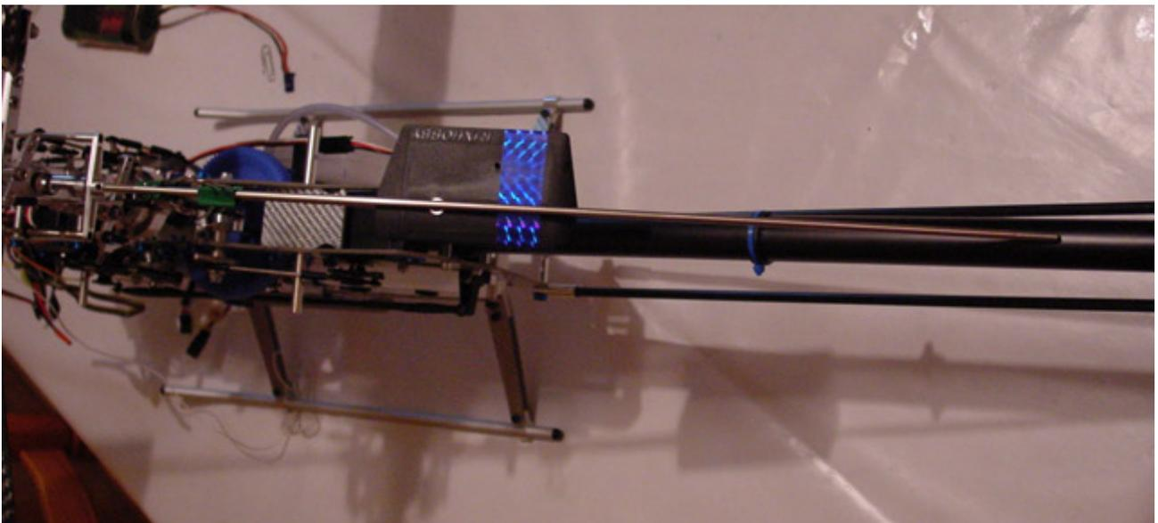
Une fois la BB dans l'axe de la poutre de queue, veillez à ce que la boule intérieure du plateau soit en face de la boule extérieure. Une fois cela fait, vous pourrez serrer la bague de phasing. 296
