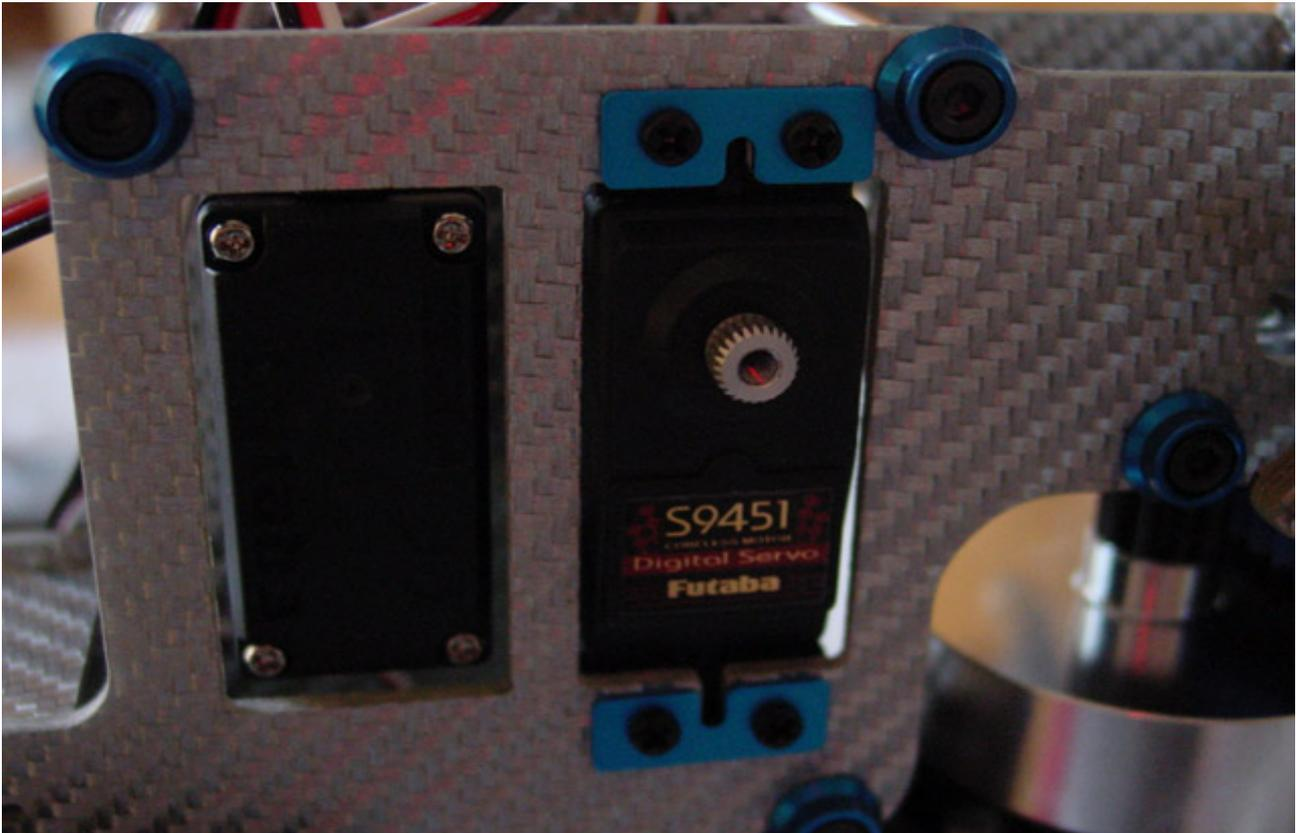
Dans mon cas, j'ai utilisé des 9451 que j'ai du installer par l'intérieur du châssis, si non ils ressortaient de trop et se trouvaient désaxés par rapport aux renvois du châssis. 237
