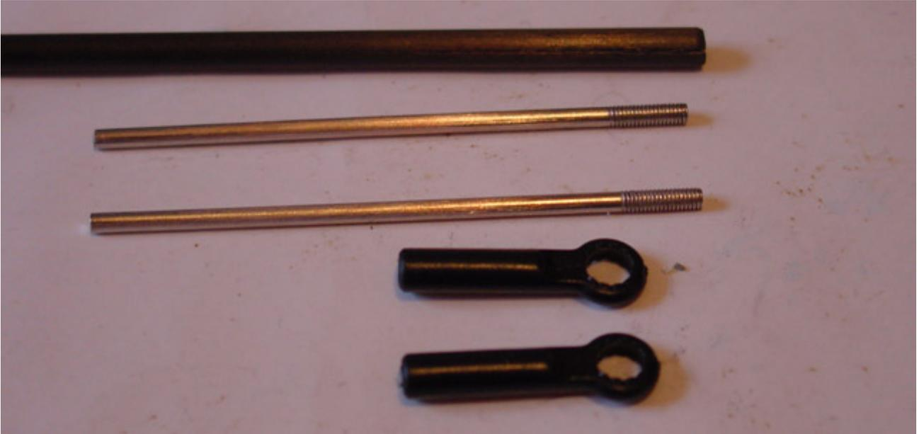
Même problème qu'à l'étape 6-11. Donc perçage du tube carbone pour éviter qu'il se fende lors de l'insertion des tringleries.
