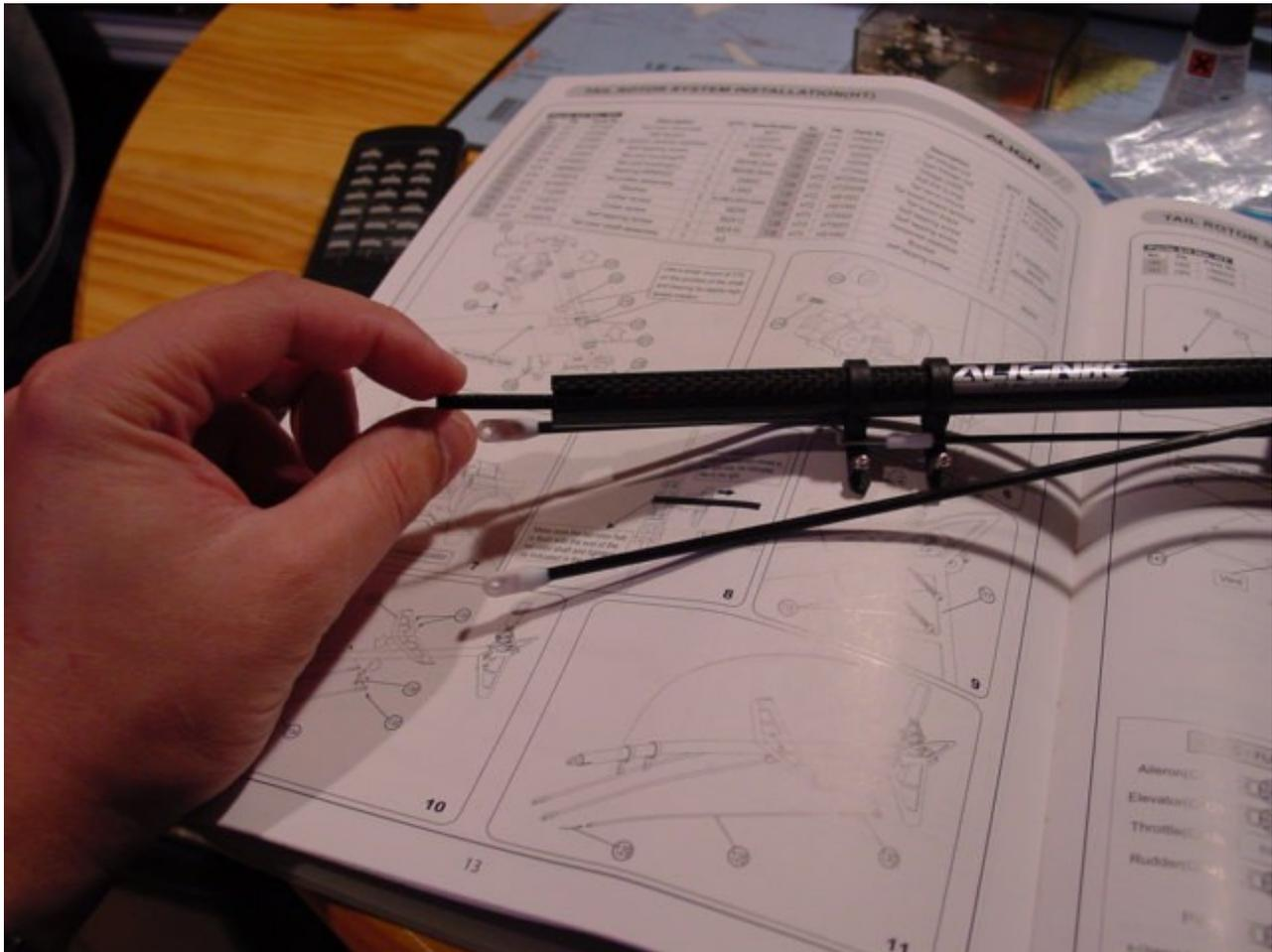
Une fois le tube de queue inséré dans le châssis, tirer le vers vous afin de tendre la courroie. Une fois la bonne tension trouvée, serrez toutes les vis qui maintiennent la poutre dans le châssis.
