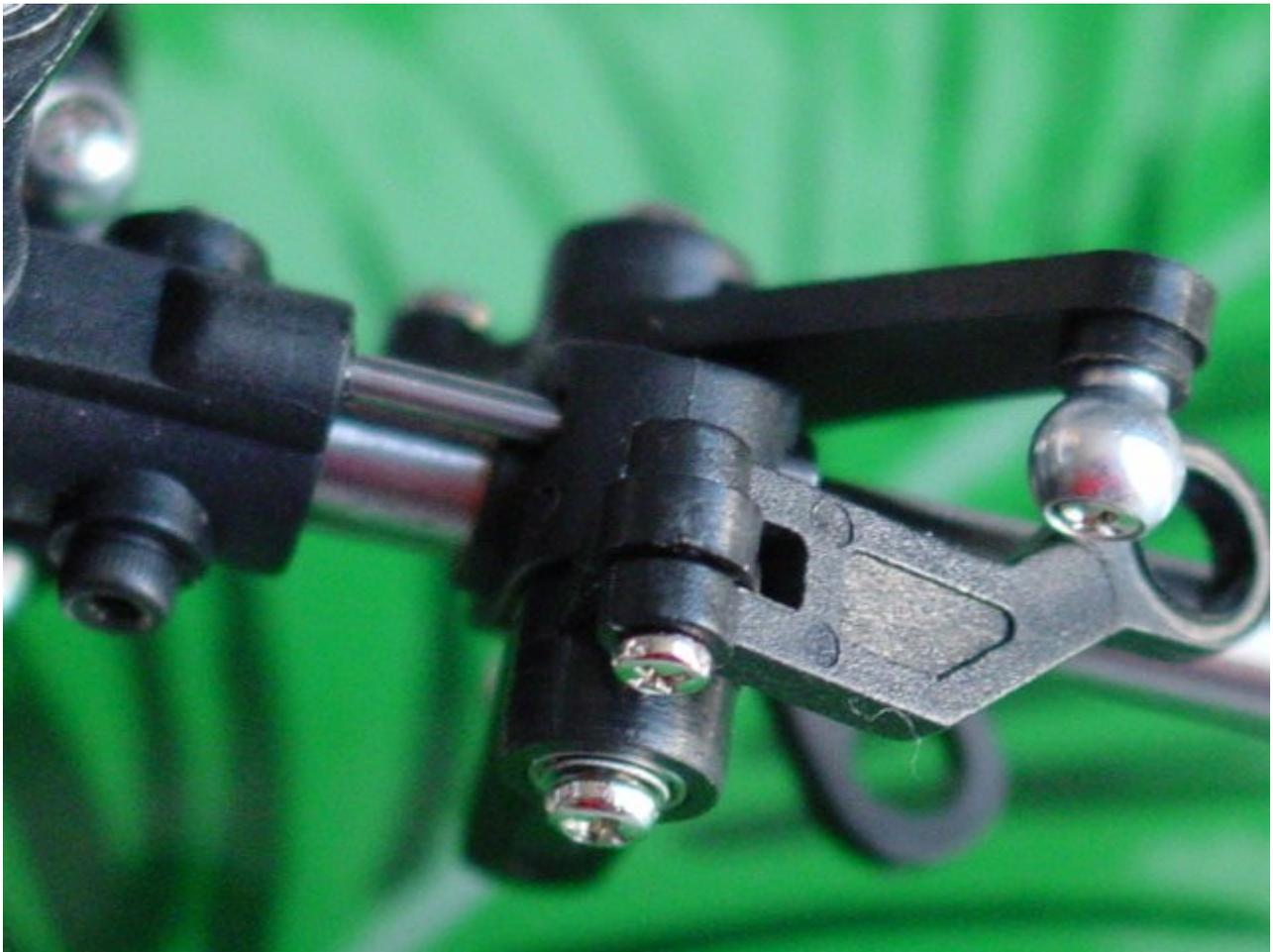
Pour le montage de l'axe, il faut tenir compte de l'écartement entre le trou de fixation et le bout de celui-ci pour le monter dans le bon sens.
